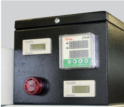
Besteht aus 3 unabhängigen Zählwerken und einem akustischem Signalgeber. Zeigt die verbleibende Anzahl noch zu setzenden Verbindern für das Werkstück.
