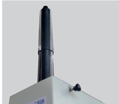
Mit Hilfe des Festanschlags kann die Stopp-Position des Zylinders präzise eingestellt und für alle nachfolgenden Einpressvorgänge beibehalten werden. Besonders bei weichen Werkstücken wird somit eine noch bessere Einheitlichkeit erreicht.
