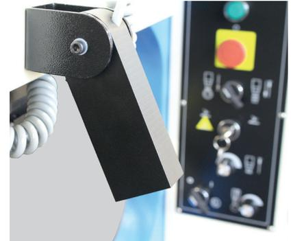
Vereinfacht die Positionierung großer Werkstücke auf die exakte Einpressposition.
