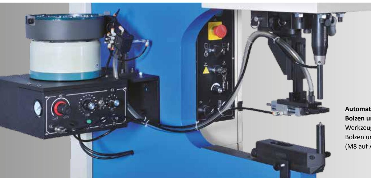
**Automatisches Werkzeug für Bolzen und Buchsen von oben**
