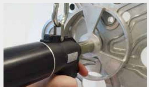
Sonderzubehör Winkeladapter zur Einhaltung der benötigten Rechtwinkligkeit zum Bauteil
