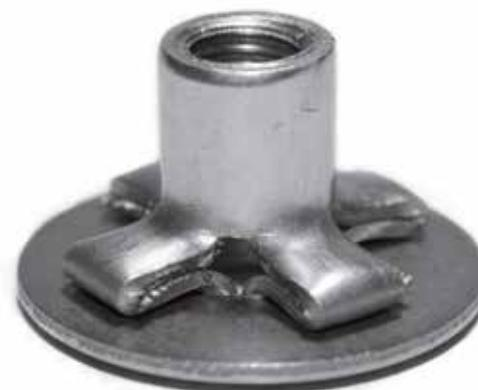
Bitte beachten Sie, dass zum Setzen der Presslaschen-Blindnietmuttern Sondergewindedorne notwendig sind. Diese finden Sie ggf. direkt bei den entsprechenden Werkzeugen.
